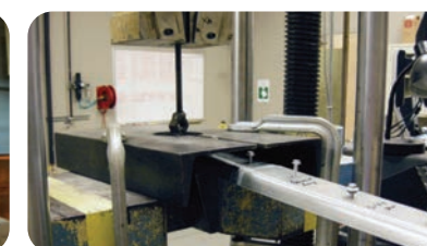
Thí nghiệm chịu kéo Tensile withdrawal test
