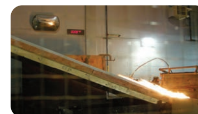
Thí nghiệm cháy lan theo tiêu chuẩn ASTM E108 ASTM E108 spread of flame test
