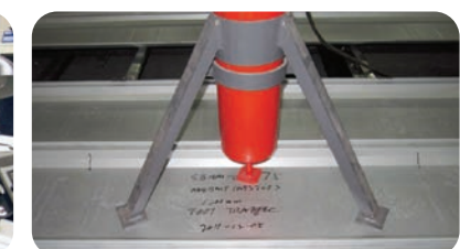
Thí nghiệm khả năng chịu tải trọng hoạt tải lắp đặt Resistance to Foot Traffic test
